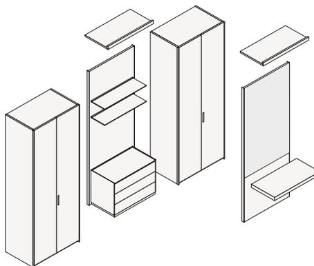
I pannelli boiserie devono essere conclusi ai lati con i profili mm 4 e completati con un coperchio superiore, con e senza luce a led. La boiserie (escluso specchio) può essere attrezzata con mensole, contenitori, modulo di cablaggio per una presa elettrica o due prese usb e mensoloni sospesi Code, con e senza luce a led.
