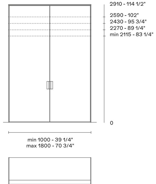
Um die Durchgangslichte zu berechnen, sind 253 mm abzuziehen
