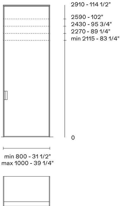
Um die Durchgangslichte zu berechnen, sind 140 mm abzuziehen
