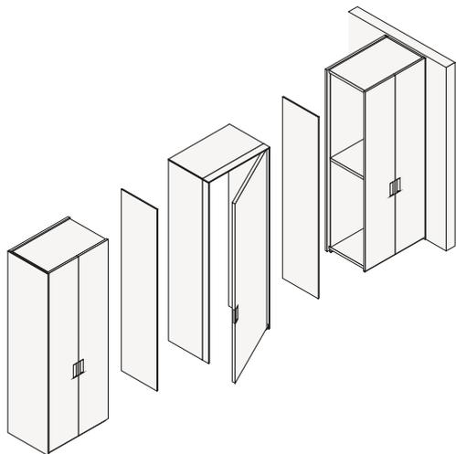
Um das Portal mit dem Schrank zu kombinieren, muss anstelle der Standardseite eine Innenseite mit der Dicke 15 verwendet werden, die zur Befestigung des Pfostens dient.
