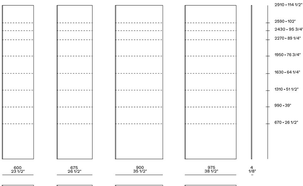
Tous les côtés visibles du lambris doivent être pourvus d'un profilé de fermeture vertical. Pour les panneaux de hauteur inférieure ou égale à 1950 mm, le profilé de fermeture horizontal supérieur est obligatoire. Les bacs et étagères peuvent être positionnés aussi bien aux hauteurs indiquées sur le schéma qu'aux hauteurs souhaitées.
