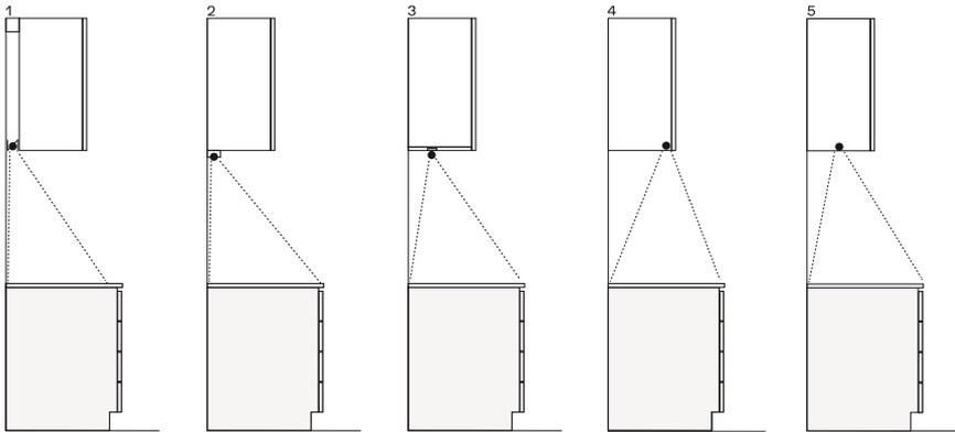
1 barra de suspensión trasera con LED, solución avanzada de poste alto de 100 mm
