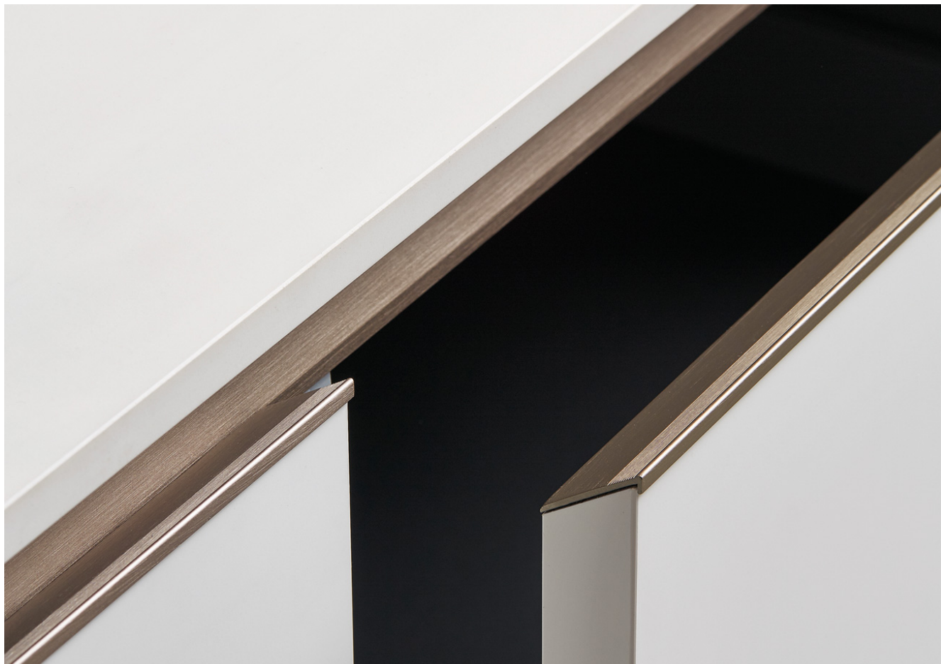
Perfil tirador champagne anodizado. Espesor puerta 22 mm. Borde de apertura cónico de 55 ° con perfil de manija.
