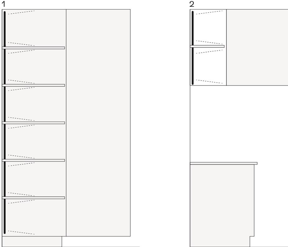
1 Säulen mit mehrreihigen vertikalen Lampen, h von 1320 bis 2280
