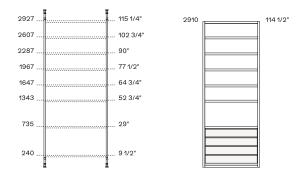
Die Abbildung zeigt die Positionierung der Regalen in Aneinanderreihung mit einem angelehntem Senzafine-Schrank.
