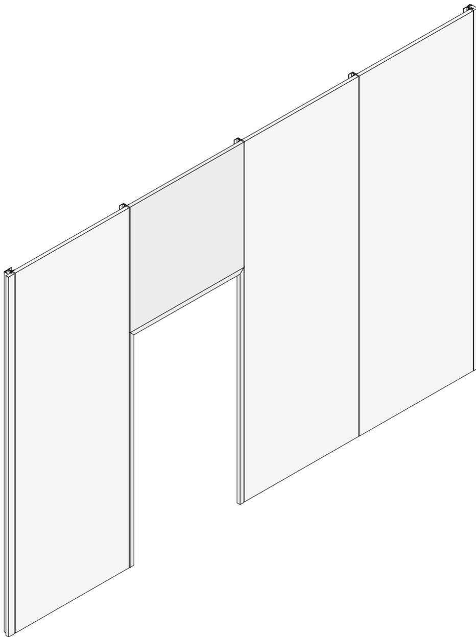
Si possono realizzare composizioni con pannelli centrali ridotti in altezza, ed eventualmente in larghezza, posizionati sospesi con profilo inferiore, per possibile passaggio porta.
