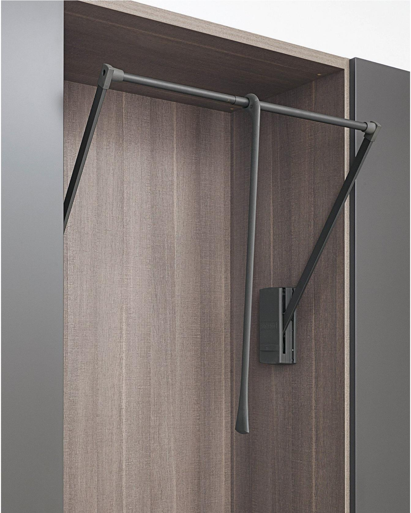
Vernice ardesia opaca. Portata massima 10 Kg. Predisposta per il fissaggio su tavole di legno. Non utilizzabile con lato telaio o lato vetro. Per vano l 458-619-780-941 - h 886.
