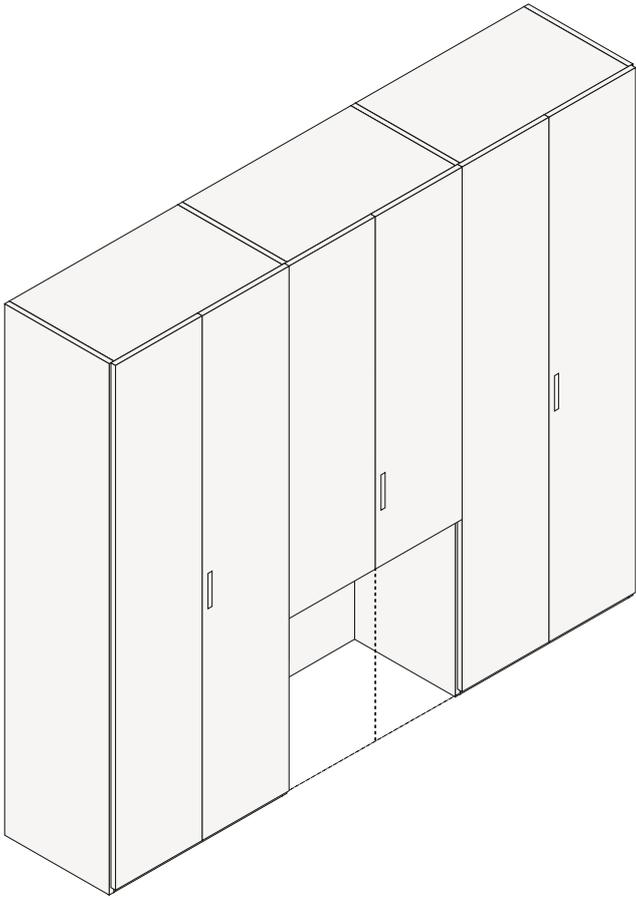
Si possono creare colonne con vano a giorno senza basamento e con schienale a terra o con ante fino a terra e con schienale parziale.
