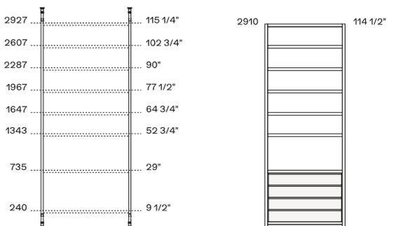
Nello schema vengono riportati i posizionamenti dei ripiani in allineamento ad un armadio Senzafine accostato.
