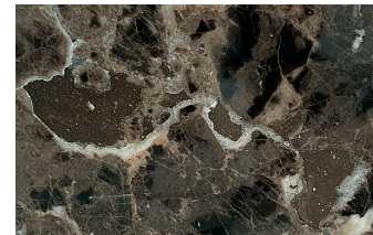
Lastra con stuccatura (dettaglio).
